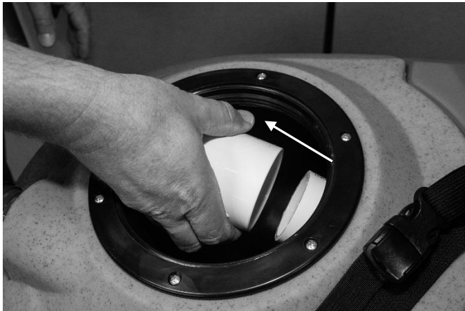
Fig. 5: Limpieza de la válvula de corte de la
