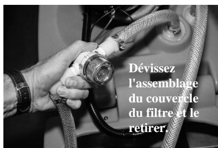
FIG. 4: Filtre d'entrée de solution de nettoyage
