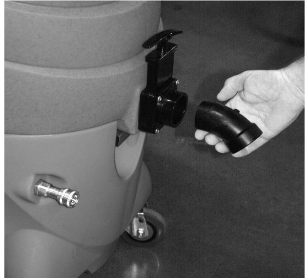
FIG. 7: Dériveur de drainage par gravité
