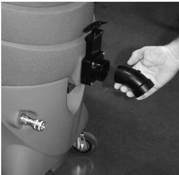
FIG. 7: Desviadora de drenaje por gravedad
