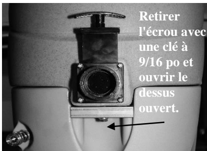
FIG. 4: Filtre d'entrée de solution de nettoyage
