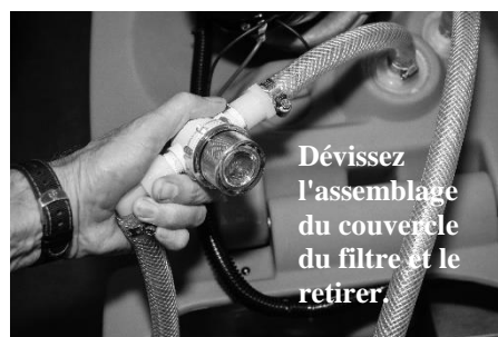
FIG. 4: Filtre d'entrée de solution de nettoyage
