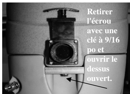
FIG. 4: Filtre d'entrée de solution de nettoyage
