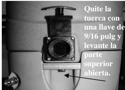
FIG. 4: Limpieza del filtro de entrada de solución
