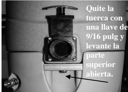
FIG. 4: Limpieza del filtro de entrada de solución
