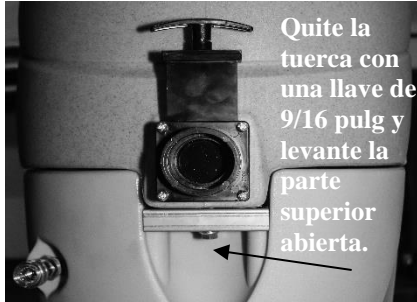
FIG. 4: Limpieza del filtro de entrada de solución
