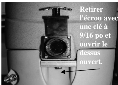
FIG. 4: Filtre d'entrée de solution de nettoyage
