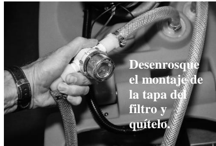
FIG. 4: Limpieza del filtro de entrada de solución
