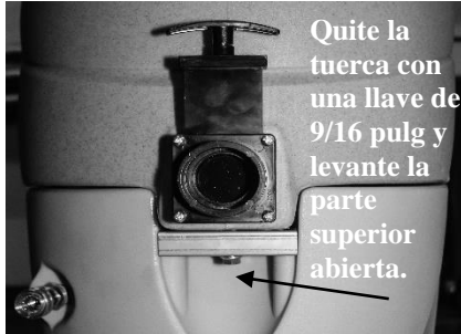
FIG. 4: Limpieza del filtro de entrada de solución
